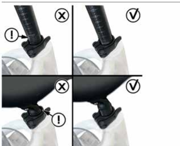
Billede 7: Maksimum og minimum indføring sadelpind
